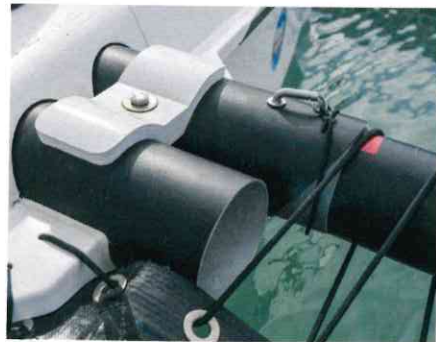
In sich verschiebbare Alurohre bilden die Beams. Das System nutzt Astus exklusiv
