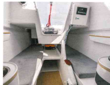
Der Schwertkasten ist zur Seite versetzt. Das schafft Beinfreiheit beim Sitzen unter Deck
