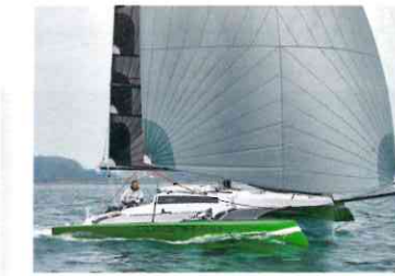
Eine Holeypunktverstellung für die Fockschot gibt es nicht – ein Manko
