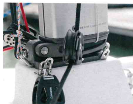
Das Rigg steht auf einem klappbaren Mastfuß und kann leicht von Hand gestellt werden
