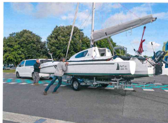
Auf dem Trailer werden die Rümpfe bis auf die straßentaugliche Breite zusammengeschoben. Wenn man weiß, wie, ist das rasch erledigt
