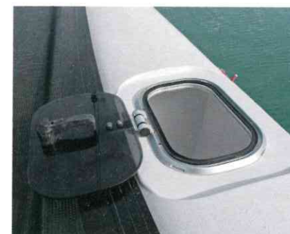
Auch in den Schwimmern gibt es Stauräume. Die Rümpfe sind mehrfach abgeschottet
