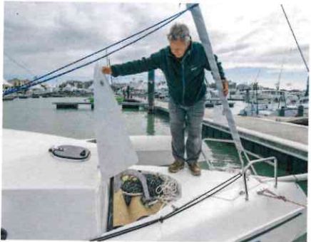
Gute Idee. In Verlängerung des Kajütaufbaus ist auf Deck ein Ankerkasten integriert
